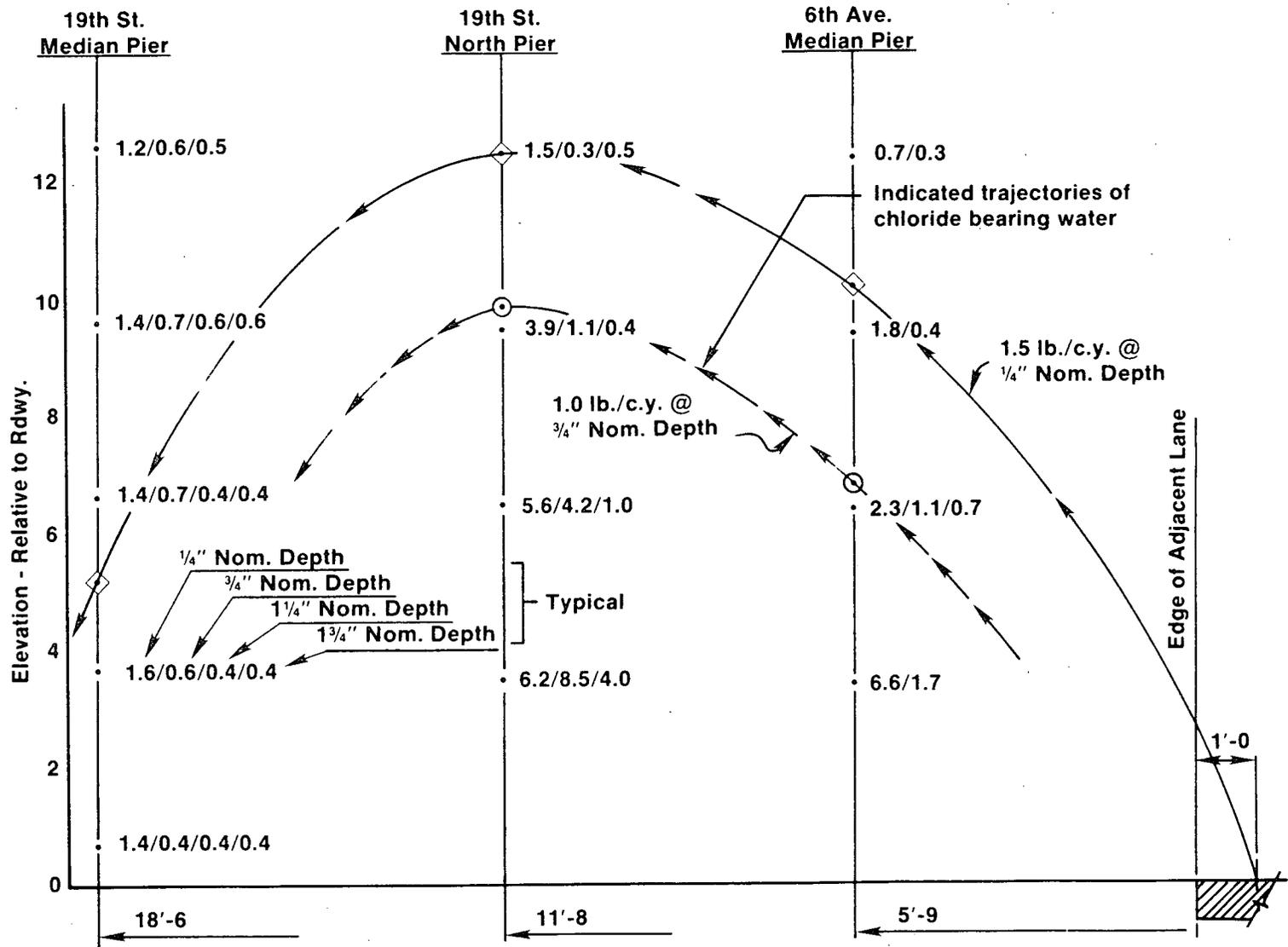
**FIGURE 1 - CHLORIDE CONTENTS
