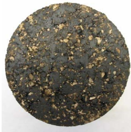
(d) Marshall compacted specimens (60°C)
